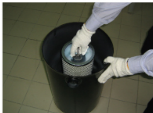
1. 在更换安全滤芯前，先确认螺母是否紧固，不要松动螺母
