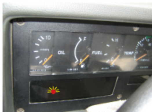
1.驾驶室仪表盘显示空滤需要更换的信号(一般每行驶 6000-8000公里后)
