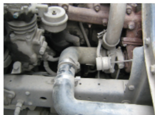
2.检查空滤与发动机之间的所有连接管路是否密封！
