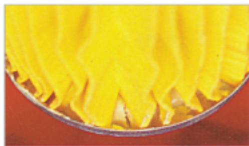
劣质滤清器的粘结出现缝隙。
