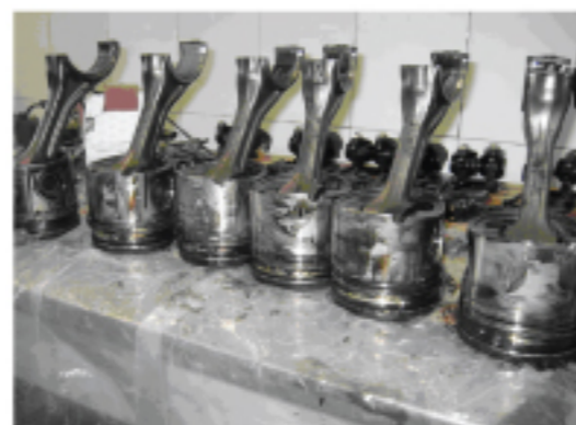
发动机活塞顶部磨损情况
