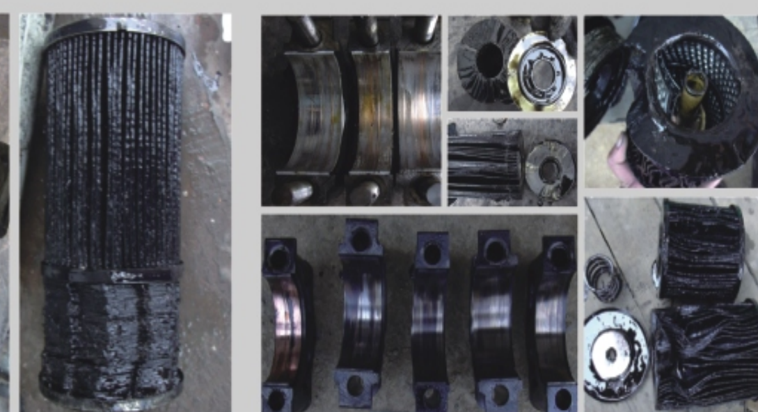
机油滤清器芯破裂导致轴瓦损坏
