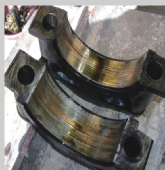
滤清器堵塞导致轴瓦损坏
