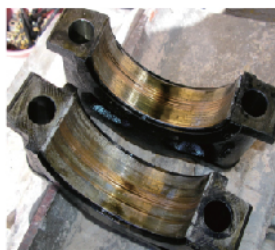
滤清器堵塞导致轴瓦损坏
