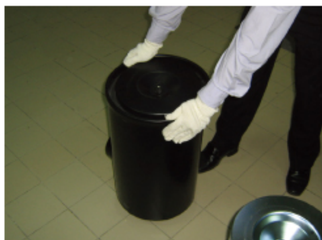
2.打开空滤器上端盖
