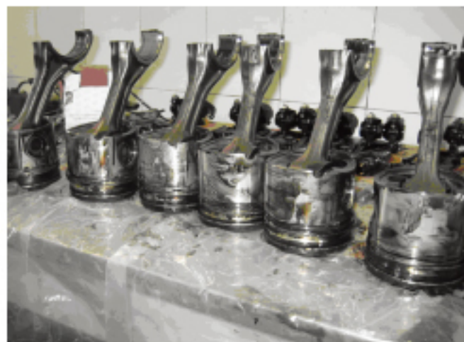
发动机活塞顶部磨损情况
