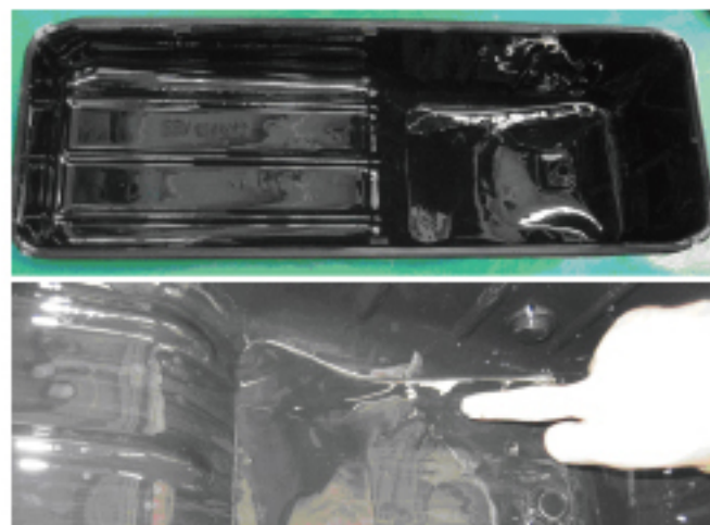
发动机油底壳粘满油泥
