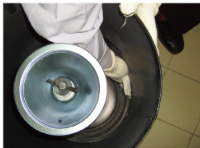
2.擦干净空滤壳体里面所有可能从安全滤芯掉入的灰尘。(不能使用压缩空气清理)
