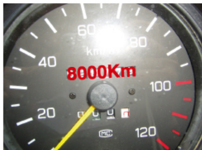
2.主滤芯已经清理5次必须更换,行驶里程超过8000km必须清理一次(特殊环境除外)
