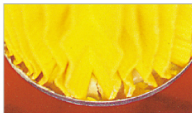
劣质滤清器的粘结出现缝隙。
