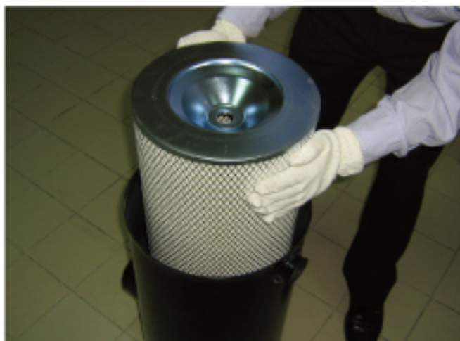
9.装回主滤芯,空滤芯的密封圈要和总成的密封平面紧贴
