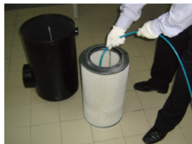
4.用压力低于5公斤压缩空气由内向外沿斜角方向吹净滤芯表面。
