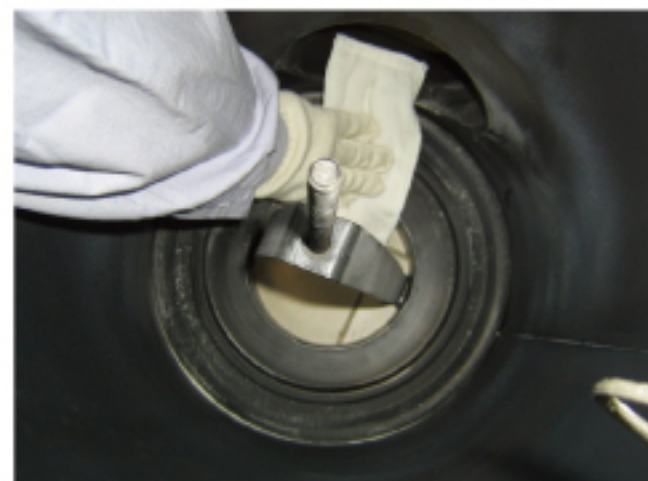
3.在装入新的安全滤芯前,用干净的湿布将滤芯安装面擦干净
