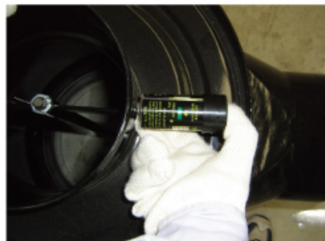
7.手动使空滤堵塞指示器复位
