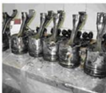
发动机活塞顶部磨损情况
