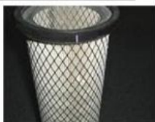
2. 当主滤芯发生破损，安装不当或已经更换3次时因该更换安全滤芯
