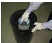
1. 在更换安全滤芯前，先确认螺母是否紧固，不要松动螺母。
