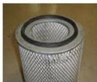
1. 主滤芯已破损
