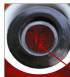
一个好的中心管设计但经较弱的生产程序控制，造成了中心管塌陷。中心管的两垂直端也会撕破或刺破滤纸。
