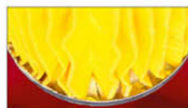
劣质滤清器的粘结出现缝隙。
