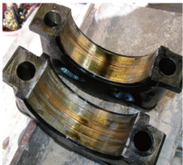
滤清器堵塞导致轴瓦损坏
